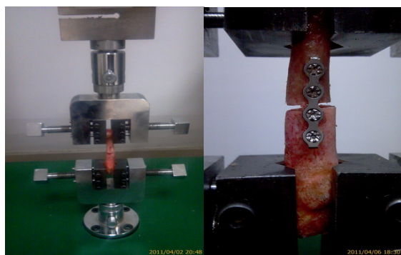
Figure 12. Axial tensile test 图 12. 轴向拉伸试验
