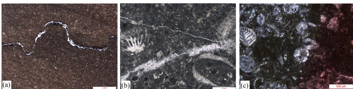
(a) 灰泥石灰岩，栖霞一段，南江桥亭，单偏光(-)；(b) 含颗粒灰泥石灰岩，栖霞一段，旺苍双汇，单偏光(-)；(c) 颗粒质灰泥石灰岩，栖霞一段，广元上江沟，单偏光(-)
