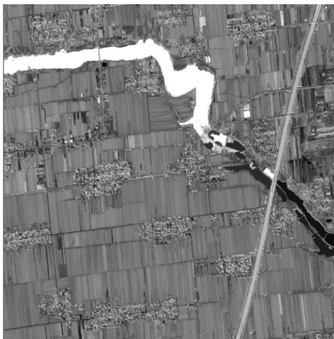
Figure 6. Ratio band 1 feature of water 图 6. 水体在第 1 波段的比值特征
