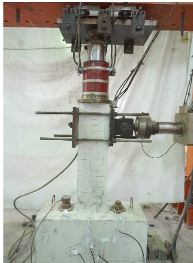
Figure 2. Loading device and test sit 图 2. 试验加载装置及现场
