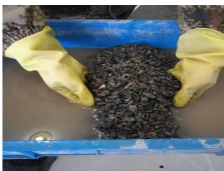
Figure 2. Stone cleaning 图 2. 石子的清洗
