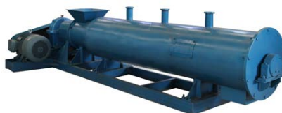
Figure 6. Tumbling granulation 图 6. 转鼓/滚筒造粒
