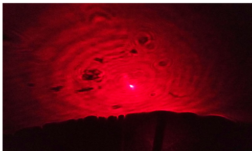
Figure 7. Position of water -100 mm, position of the screen 500 mm 图 7. 水滴位置-100 mm 光屏位置 500 mm
