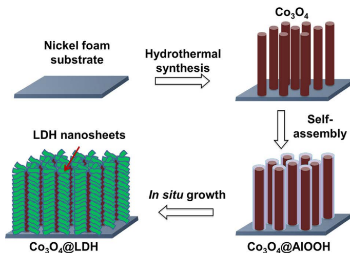
Figure 3. In situ growth synthesis of \text{Fe}_3\text{O}_4@\text{SiO}_2@\text{LDH} [14] 图 3. 原位生长法合成 \text{Co}_3\text{O}_4@\text{NiAl-LDH} 的方案[14]
