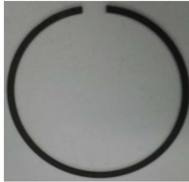
Figure 5. Piston ring state diagram under free state 图 5. 自由状态下活塞环状态图
