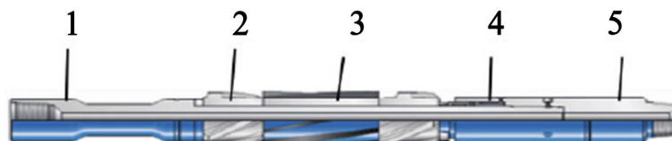
1: 上部接头; 2: 扶正块; 3: 毛刷; 4: 应急解卡套; 5: 下部接头。
