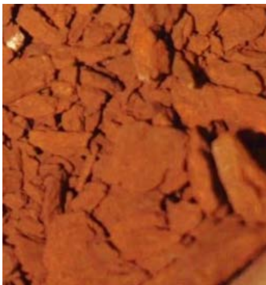
Figure 3. Red scale on piston head 图 3. 活塞头红色结垢物
