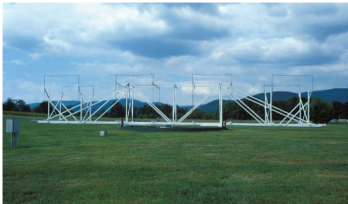
Figure 2. Replica of the antenna used by Karl G. Jansky [7] 图 2. 卡尔·詹斯基使用的天线复制品[7]
