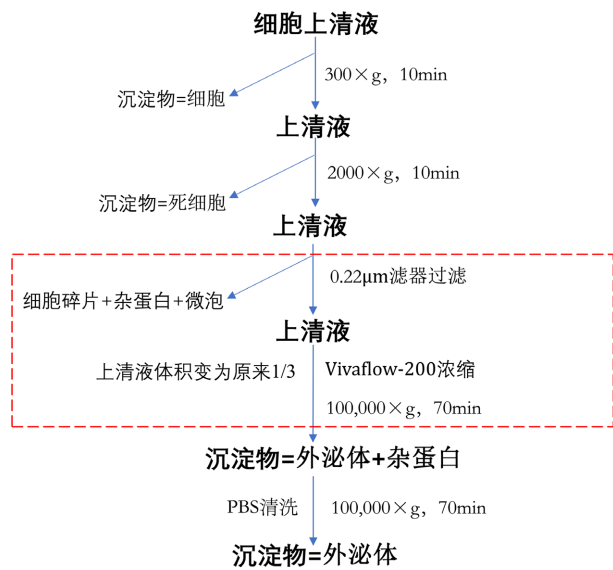
Figure 1. Exosome separation process 图 1. 外泌体分离流程
