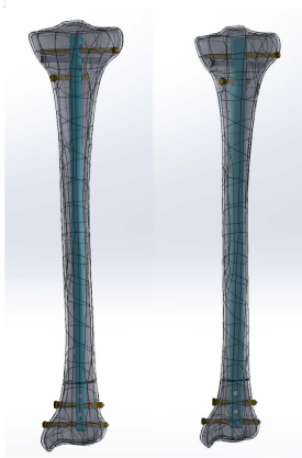
Figure 5. Fracture model and intramedullary nail internal fixation model 图 5. 骨折模型与髓内钉内固定模型
