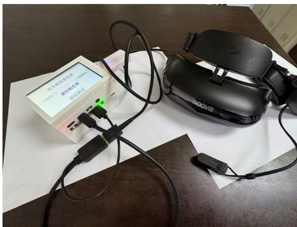
Figure 2. Prefrontal single-channel EEG acquisition device 图 2. 前额单通道脑电波采集仪器
