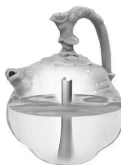
倒灌壶内部透视示意图
