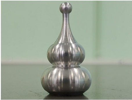
Figure 3. The CNC machining center training project—“Gourd” 图 3. 数控加工中心实训作品——“葫芦”
