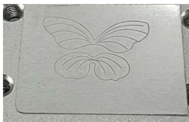
Figure 2. Laser engraving patterns 图 2. 激光雕刻图案
