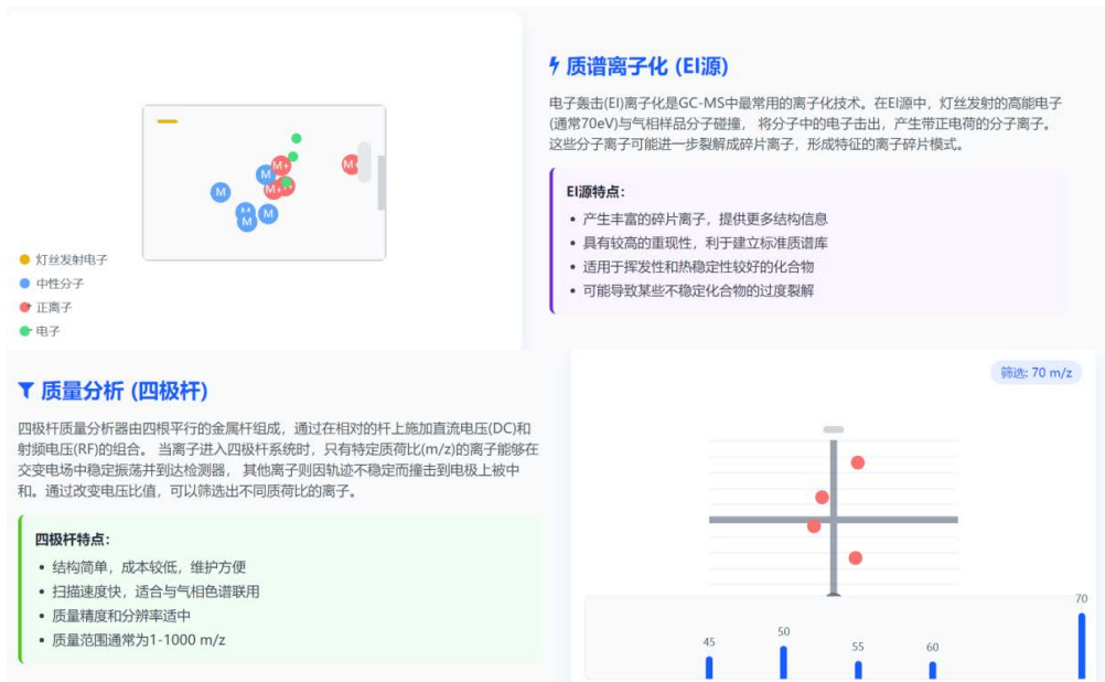
Figure 3. GUI for simulating the Electron Ionization (EI) process 图 3. EI 源离子生成过程模拟界面图
