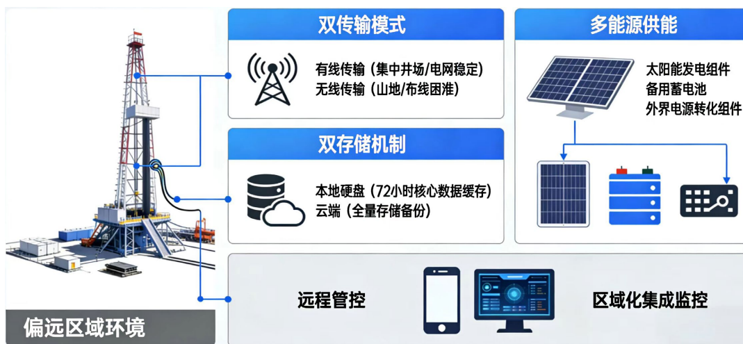
Figure 6. Schematic diagram of multi-energy supply and dual transmission mode 图 6. 多能源功能双传输模式示意图
