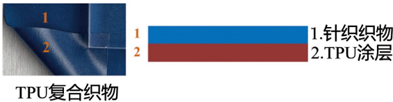
Figure 2. Actuator makes materials 图 2. 执行器制作材料
