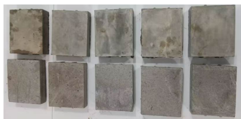
Figure 2. Floor surface layer mortar specimen 图 2. 地坪面层砂浆试件
