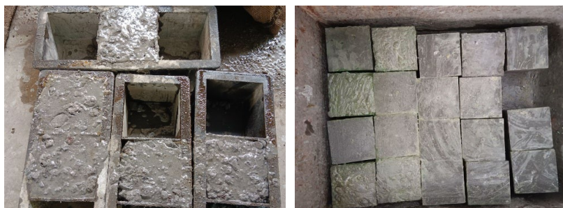
Figure 1. Floor grass-roots concrete specimen 图 1. 地坪基层混凝土试件
