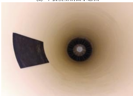
(b) 平板模型在风洞内安装
