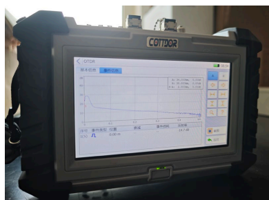
Figure 1. KD1000 OTDR tester 图 1. KD1000 型 OTDR 测试仪
