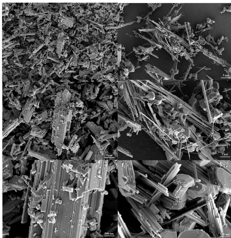
Figure 5. SEM images of NMNO(1) (a, c, e) and NMNO(2) (b, d, f) 图 5. 样品 NMNO(1) (a、c、e)与 NMNO(2) (b、d、f)的 SEM 图像
