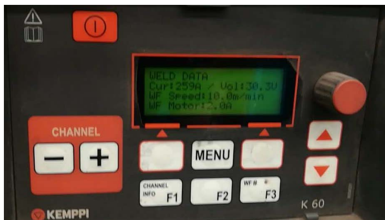
Figure 9. Robot system welding parameter setting picture 图 9. 设备接收焊接参数图片
