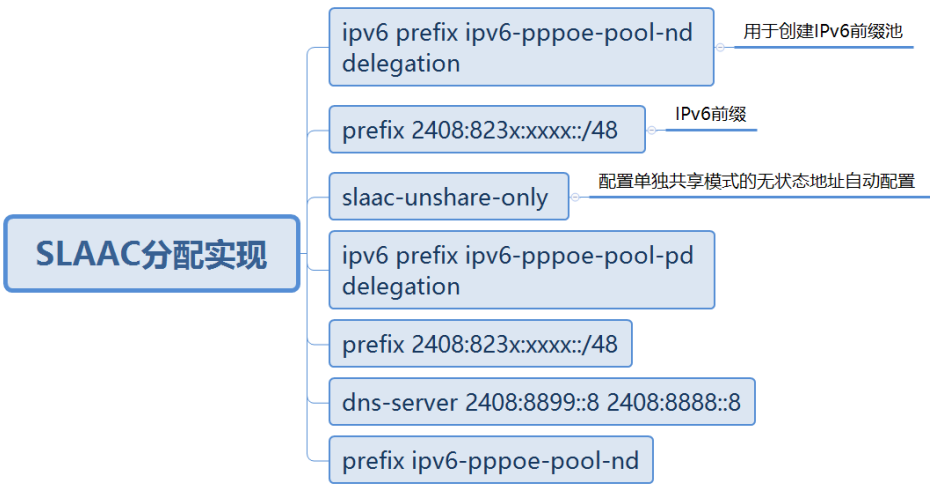
Figure 1. SLAAC implementation methodology 图 1. SLAAC 实现方法
