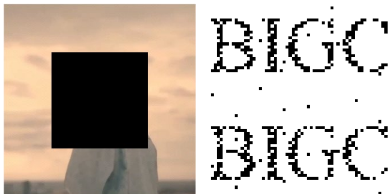
Figure 10. billkin video frame after cutting the center part and the extracted watermark 图 10. 经过剪切中心部分后的 billkin 视频帧和提取出的水印
