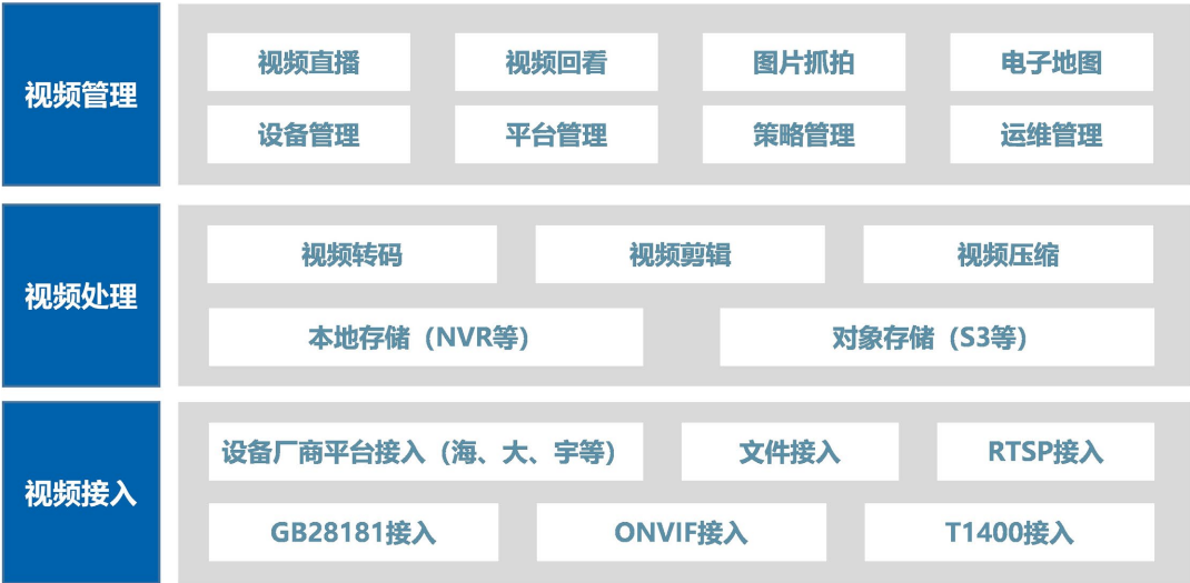
Figure 6. Function architecture of basic video processing module 图 6. 基础视频处理模块功能架构
