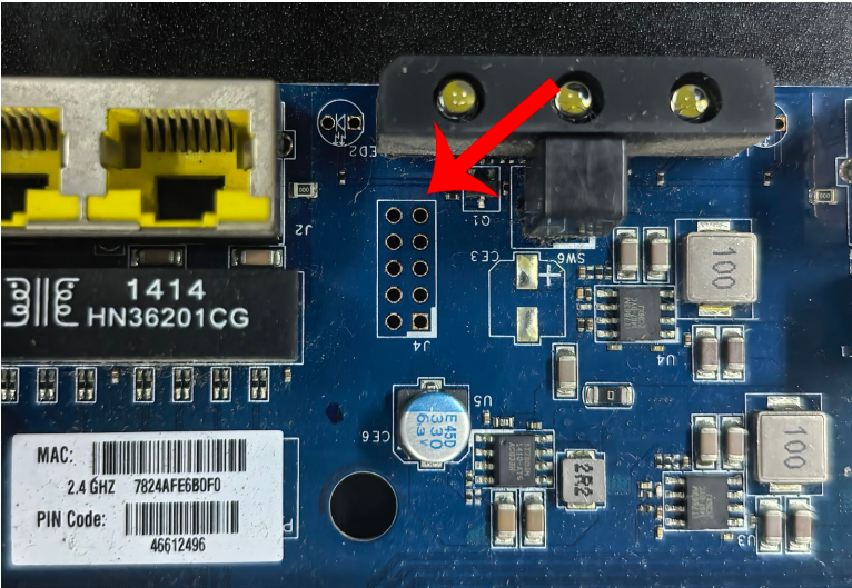
Figure 7. 10PIN JTAG pins on router main-board 图 7. 路由器主板 10PIN 规格 JTAG 引脚
