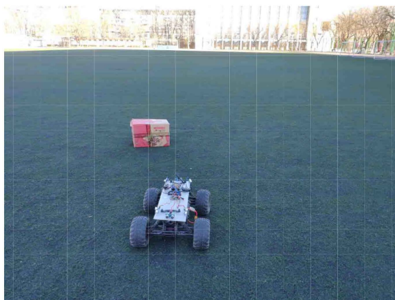
Figure 17. U1, U2 ultrasonic detection of obstacles 图 17. U1、U2 号超声波检测到障碍物
