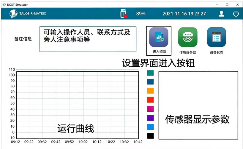
Figure 3. HMI of the container plant factory control system 图 3. 集装箱植物工厂控制系统人机交互界面
