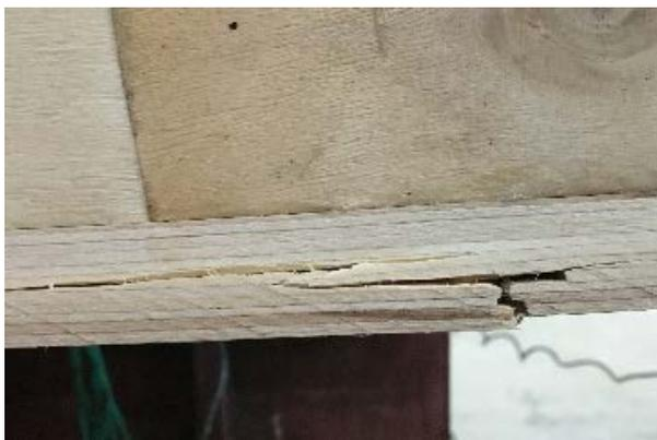
(a) 箱型梁底部受拉破坏
