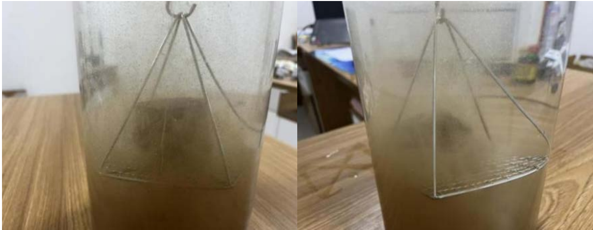
(a) 未固化粉质粘土崩解过程
