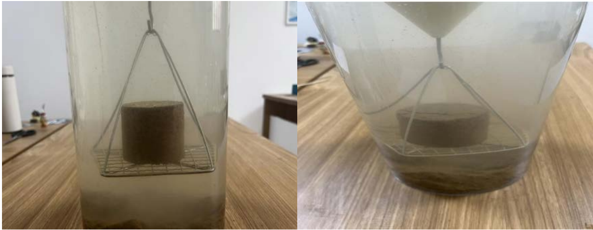
(b) 瓜尔豆胶固化粉质粘土崩解过程
