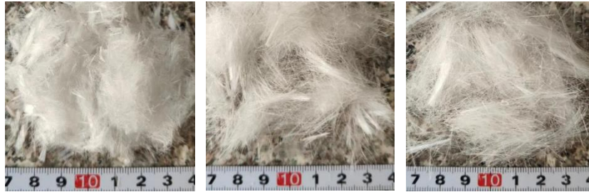
Figure 1. Chopped polypropylene fiber (6 mm, 12 mm, 18 mm) 图 1. 短切聚丙烯纤维(依次为 6 mm、12 mm、18 mm)
