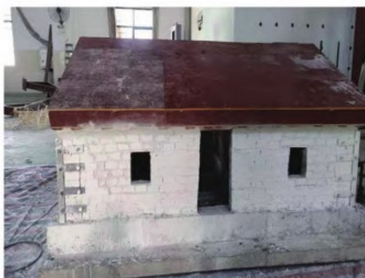
Figure 2. A volcanic stone masonry model strengthened with FRP 图 2. 用 FRP 加固的火山石砌体模型
