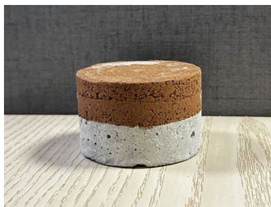
(b) 混凝土 - 冻土二元试块
