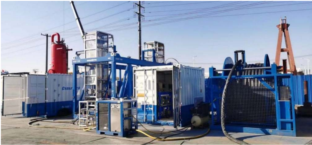
Figure 3. High-pressure jet testing apparatus 图 3. 高压射流试验装置图
