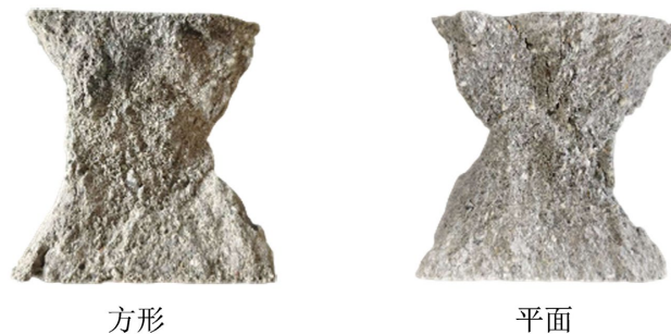
Figure 6. Compressive failure mode 图 6. 抗压破坏模式
