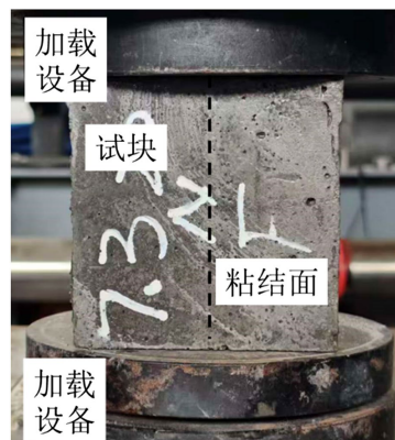
Figure 4. Schematic diagram of compression test 图 4. 抗压试验示意图
