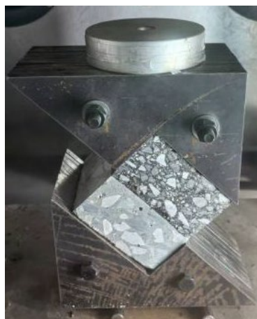
Figure 3. Schematic diagram of oblique shear test 图 3. 斜剪切试验示意图
