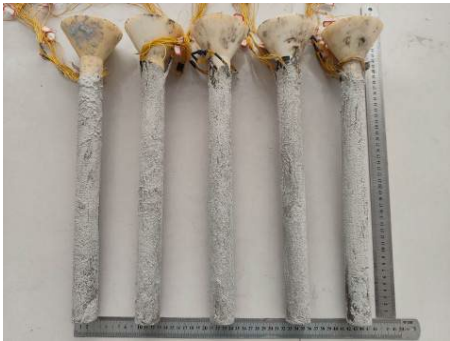
Figure 1. Model piles 图 1. 模型桩
