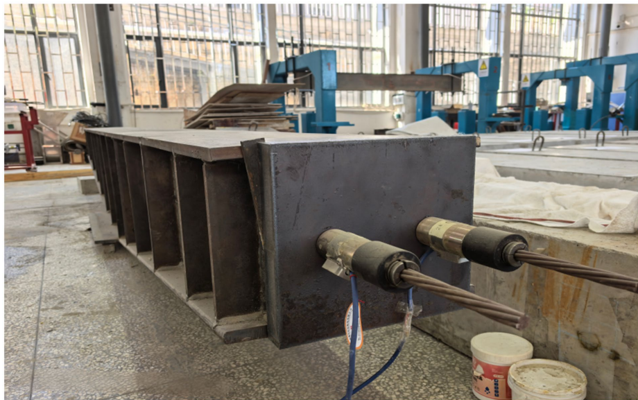
Figure 1. Relaxation testing apparatus for steel strands used in this experiment 图 1. 本次试验所使用的钢绞线松弛设备
