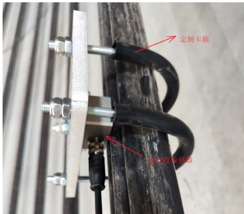
Figure 3. Acceleration sensor of external cable fastened by a custom clamp 图 3. 使用定制卡箍紧固的体外索加速度传感器
