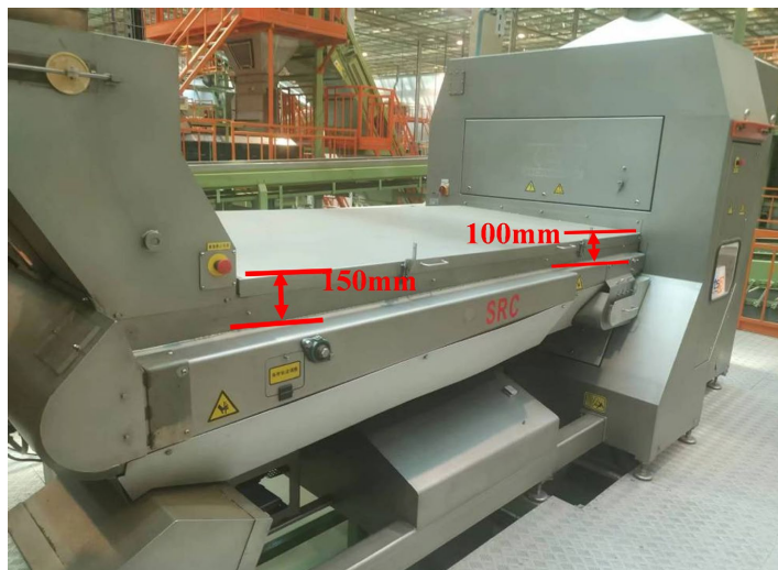
Figure 2. Blockage of foreign body rejector 图 2. 异物剔除器阻塞部位
