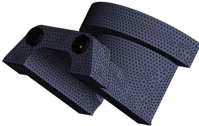
Figure 3. Mesh of 1/4 housing 图 3. 1/4 壳体网格划分图
