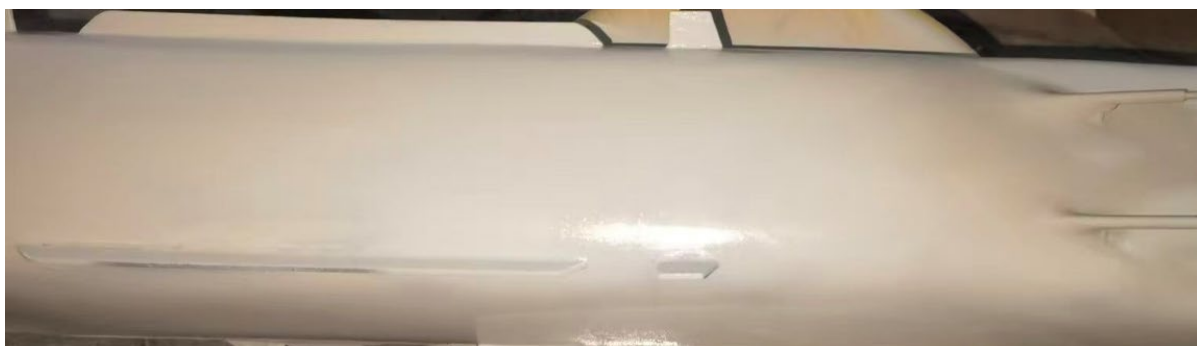
Figure 18. Hull primer printing 图 18. 船身底漆喷涂
