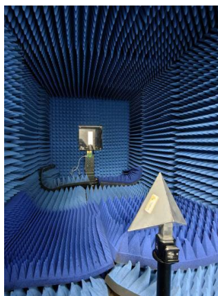
Figure 9. Antenna array under testing 图 9. 天线阵方向图测试
