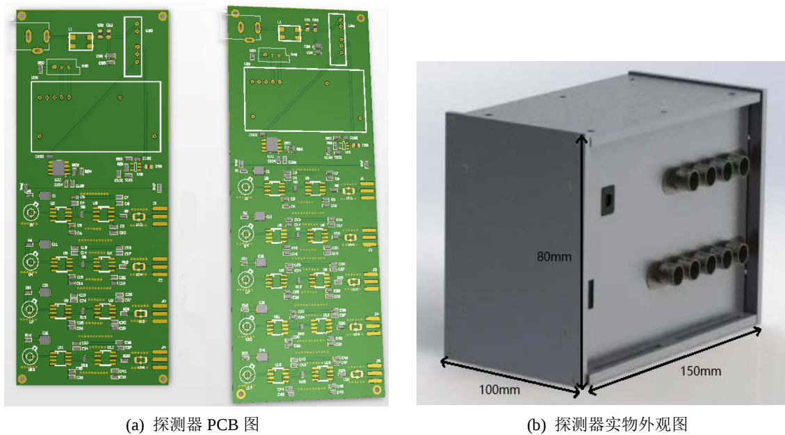
Figure 5. Detector PCB map and physical map 图 5. 探测器内部 PCB 图和实物外观图
