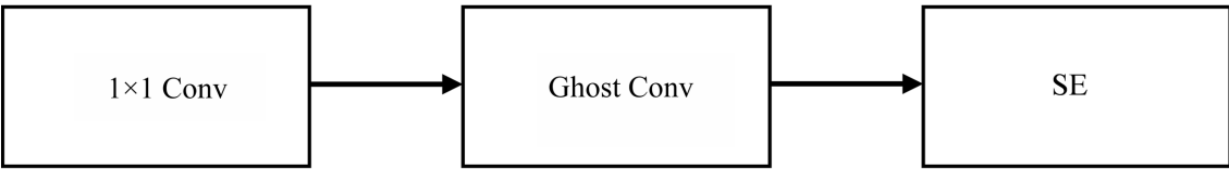
Figure 7. G-S-Fire module 图 7. G-S-Fire 模块
