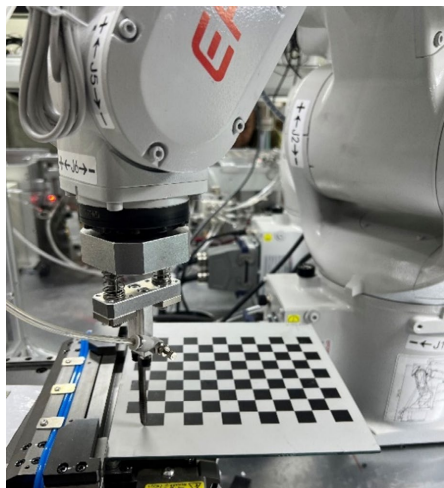
Figure 6. Nine point calibration process diagram 图 6. 九点标定过程图
